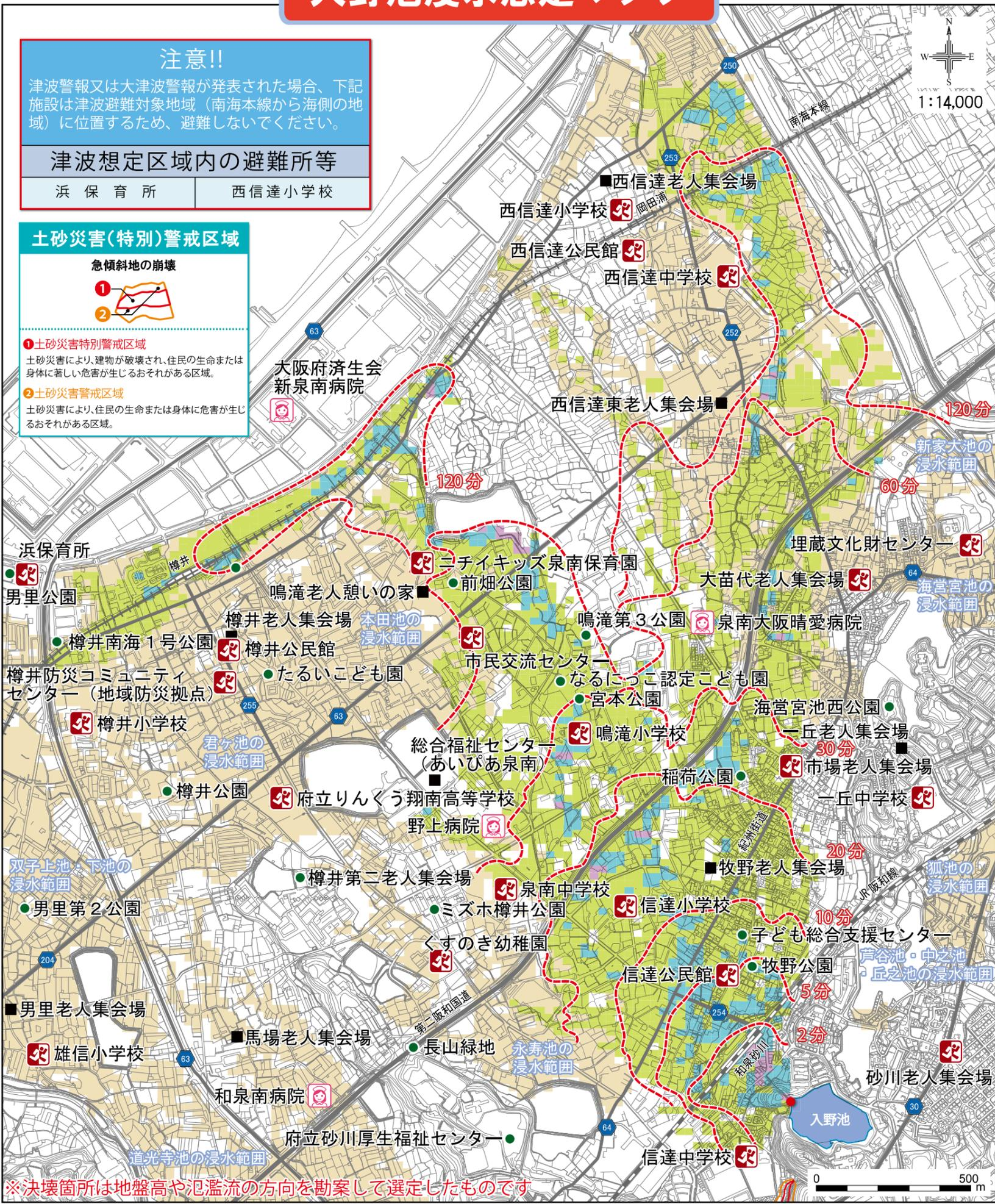
「入野池浸水想定マップ」はため池の北西側の堤防が決壊した場合を想定した浸水区域と浸水深、浸水が到達するおおよその時間を表示しています。
