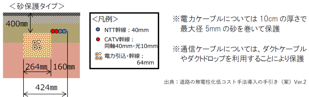
図 4 - 7 直接埋設方式
