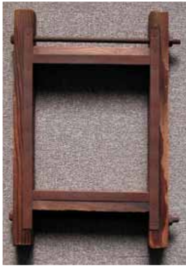
写真6「手抜き」の木枠 耐火レンガ用。昭和20年代に使用
